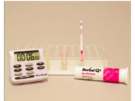
9. 放入全新的 Q+ Aflatoxin 測試條入透明樣品杯中(按照箭頭方向放入樣品杯)，反應 6 分鐘。
